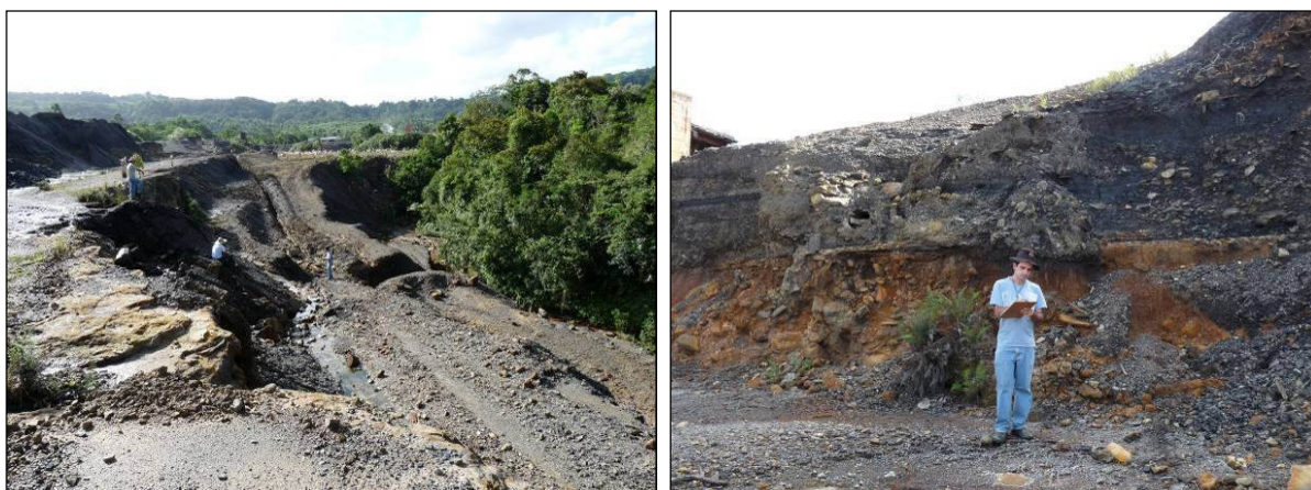
Figura 26 - Vista da deposição do rejeito do beneficiamento do carvão nas margens do rio
