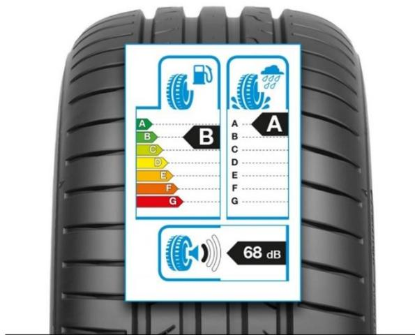
**Aderência em piso molhado** – Mede a capacidade de travagem do pneu em piso molhado.
